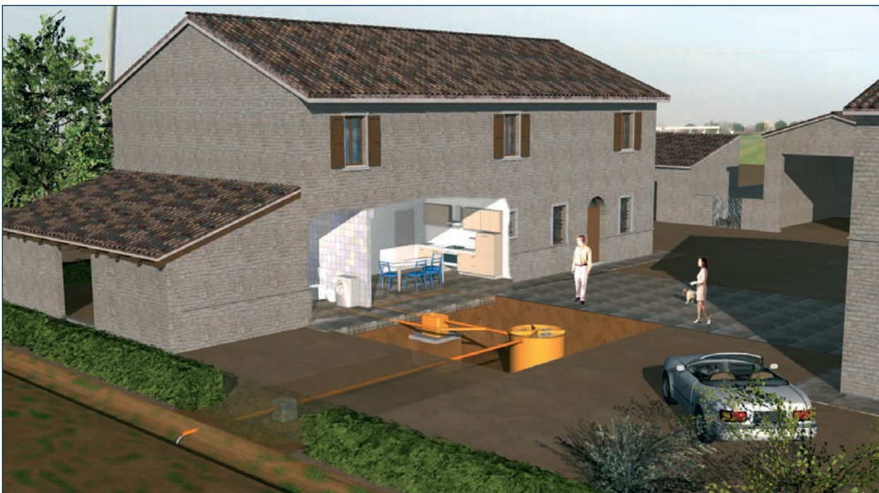
IMPIANTO UNIVERSALE A PORTATA COSTANTE FINO A 35 AE per scarico sul suolo
